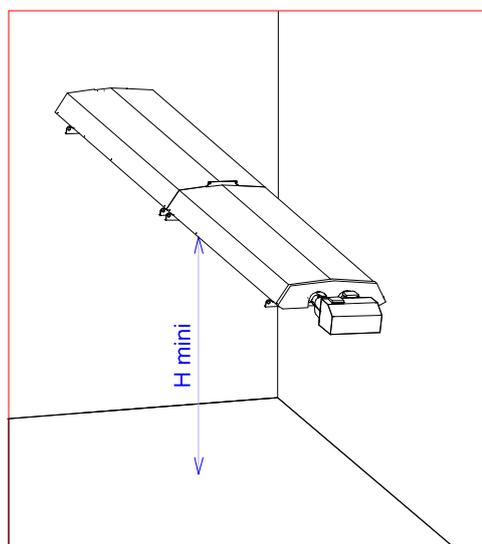
La hauteur minimale de fixation sous tubes recommandée par rapport au sol dans le cas de chauffage global d'un bâtiment clos est de :
