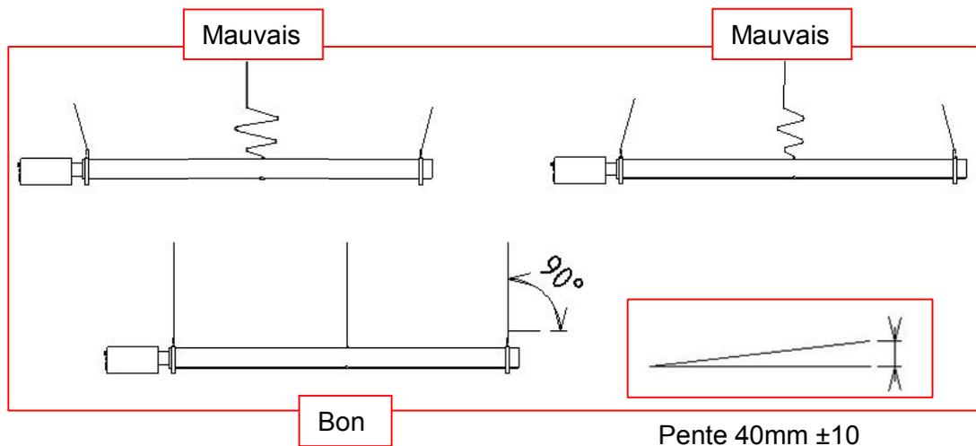
La pente totale de l'appareil doit être de 40mm ±10 en direction du coude.
