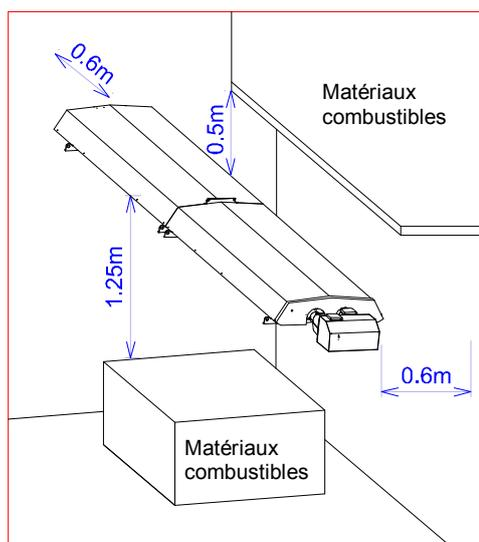
L'appareil doit être placé à bonne distance des matériaux combustibles non protégés.
