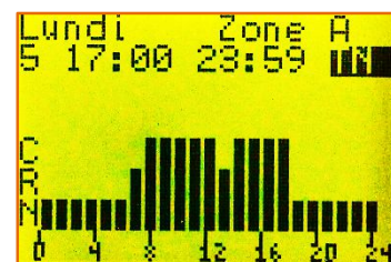
Régler la consigne désirée [TC : Confort / TR : Réduit / TN : Nuit / OFF] (à la validation, passage au pas suivant)
