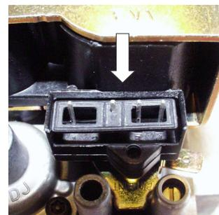
❑ Assemblage du bloc électronique 579 DBC sur la vanne 840 SIGMA
