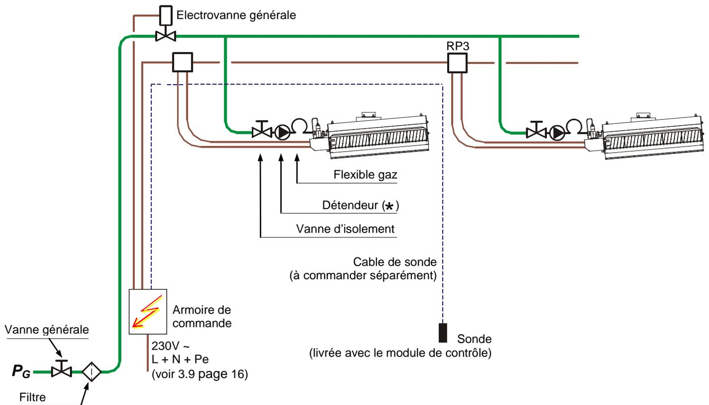
**\* Prévoir un détendeur adéquat si la pression de distribution  $P_G$  est supérieure à la pression nominale des radiants  $p$ .**
