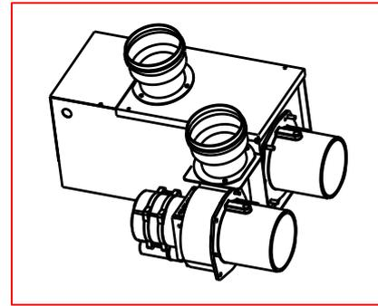
Die maximale Länge der geraden Verbindung für die Abgasführung beträgt 8 m, diese gilt auch für die Verbrennungsluftzufuhr. Wand- oder Dachdurchführungselemente werden hier nicht berücksichtigt.
