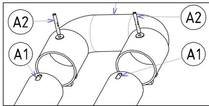
Brennereinheit (H) auf das Strahlrohr schieben und mit den Schraube (A2) sichern.
