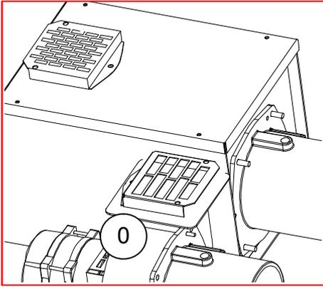
Das Gerät wird generell ohne Abgasstutzen geliefert. Die Gas-Dunkelstrahler können an eine Einzelabgasanlage angeschlossen werden und führen ihre Abgase direkt ins Freie durch, das Dach oder die Außenwand ab.
