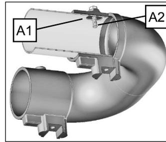
Schieben Sie den Ventilatorblock (J) auf das rechte Rohr, und drehendrehen die Befestigungsschr drehen die Schraube (A2) so durch das Langloch (A1) in das Strahlrohr daß der Ventilatorblock fixiert wird.
